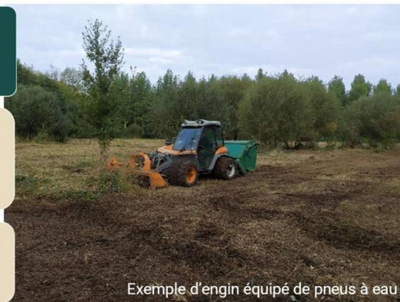
Exemple d'engin équipé de pneus à eau
